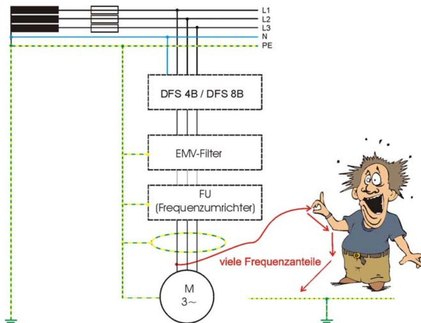
**Beispiel:** Der Motor wird mit einer Ausgangsfrequenz (auch als Maschinen- oder Motorfrequenz bezeichnet) von 10 Hz betrieben. Die Schaltfrequenz (auch als Chopper - oder Taktfrequenz bezeichnet) des FU beträgt 8 kHz.
