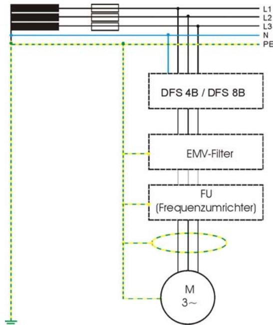
Zur Einhaltung der einschlägigen EMV - Vorschriften (**Elektromagnetische Verträglichkeit**) darf der FU nur über ein vorgeschaltetes EMV - Filter, welches auch schon im FU integriert sein kann, betrieben werden. Da die pulsweitenmodulierte Ausgangsspannung des FU äußerst steiflankig ist und somit Oberschwingungen hoher Amplituden und Frequenzen enthält, darf der Motor ebenfalls zur Einhaltung der EMV - Vorschriften nur über eine abgeschirmte Leitung mit dem FU verbunden werden.
