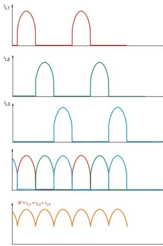
Der Fehlerstrom  $i_F$  ergibt sich aus einer Addition der einzelnen Ströme  $i_{L1}$ ,  $i_{L2}$  und  $i_{L3}$  in den drei Leitern L1, L2 und L3. Die einzelnen Leiterströme  $i_{L1}$  bis  $i_{L3}$  stellen pulsierende Gleichfehlerströme mit längerer Nullpunktberührung dar, die sich aus der Kommutierung von drei der 6 Gleichrichterdiolen ergeben.
