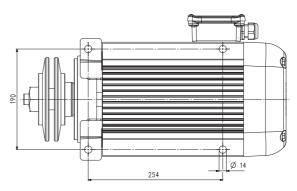
Gleichbleibende Länge bei Ausführung mit mechanischer Bremse!!
